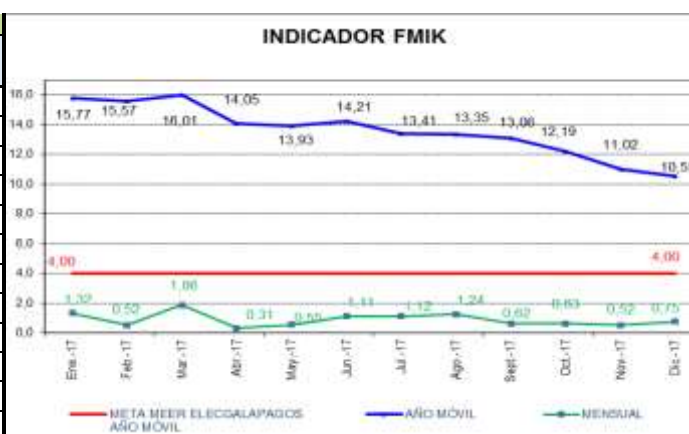
Figura 11. Frecuencia de interrupción del sistema en cabeceras de alimentadores, en el año 2017
