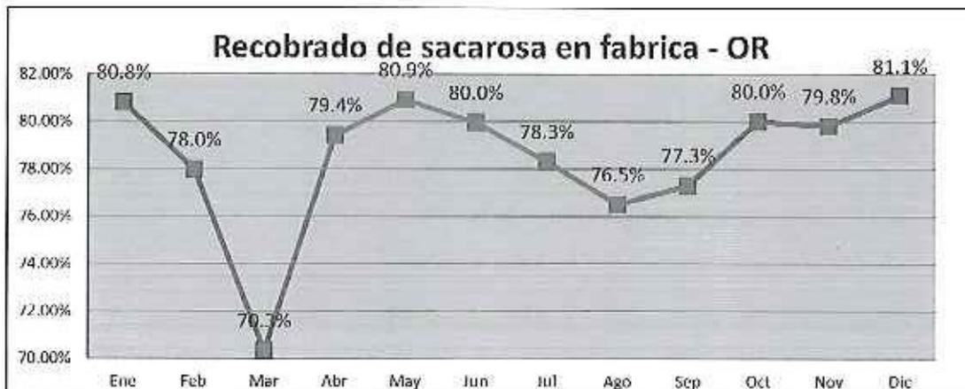
Adicionalmente, el nuevo sistema de preparación de caña de mayor capacidad con una desfibradora de mayor velocidad periférica para una mejor preparación de la caña tuvo un daño el 15 de Octubre 2015 que afectó la vibración de sus bases, las mismas que colapsaron y se tuvo que volver al procedimiento anterior.
