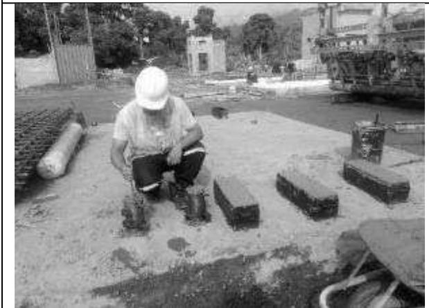
Muestras de hormigón para control de resistencia
