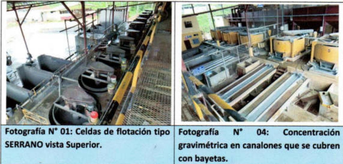
El proceso de concentración gravimétrica se realiza con la utilización de canalones, cubiertos con bayetas, cabe mencionar que este proceso se lo realiza de vez en cuando, netamente para saber si existen partículas de oro libre dentro del mineral.
