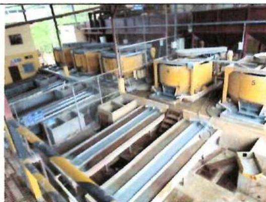
**Fotografía N° 04: Concentración gravimétrica en canalones que se cubren con bayetas.**
