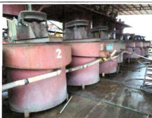
**Fotografía N° 02: Celdas de flotación tipo SERRANO vista frontal.**
