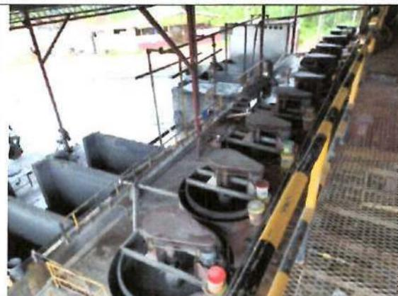
**Fotografía N° 01: Celdas de flotación tipo SERRANO vista Superior.**
